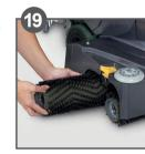
Bürsten entfernen, unter fliessendem Wasser reinigen, trocknen lassen
