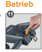
Starten Sie die Maschine durch Drücken des NFC-Schlüssels
