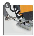
Absenken der Bürsteneinheiten mit Hilfe des Fusspedals
