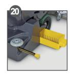
Kehrgutbehälter und Reinigungsmittelverteiler entleeren und reinigen
