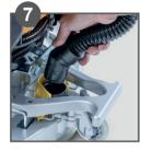
Saugbalken montieren und mit dem Absaugschlauch verbinden
