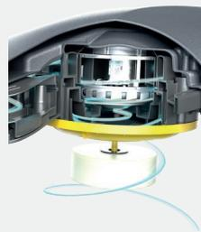
Die TASKI ULTIMAXX Reihe ist serienmäßig mit der patentierten TASKI Flüstertechnologie ausgestattet. Die einzigartige Luftstromführung garantiert optimale Absaugung bei nachhaltiger Geräuschreduktion auf bis zu 60dB(A). Der optionale HEPA 13-Filter entfernt zuverlässig Staub und Mikroorganismen aus der Abluft und schützt die Raumluft im Reinigungsbereich.
