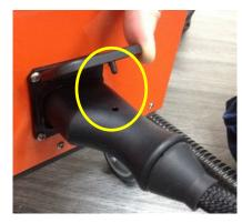
确保蒸汽管无法拔 出。
