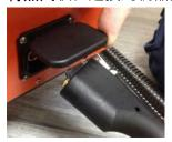
**确保将其全部插入**,**并将盖板上的**销钉锁入软管上的孔中。
