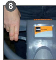
8 Um die Maschine zu starten, den gelben Sicherheitsknopf seitlich gleichzeitig mit dem oberen Starthebel drücken.
