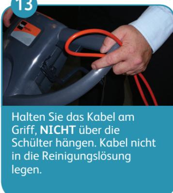
Halten Sie das Kabel am Griff, **NICHT** über die Schulter hängen. Kabel nicht in die Reinigungslösung legen.
