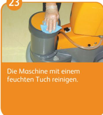
Die Maschine mit einem feuchten Tuch reinigen.
