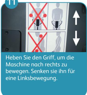
Heben Sie den Griff, um die Maschine nach rechts zu bewegen. Senken Sie ihn für eine Linksbewegung.
