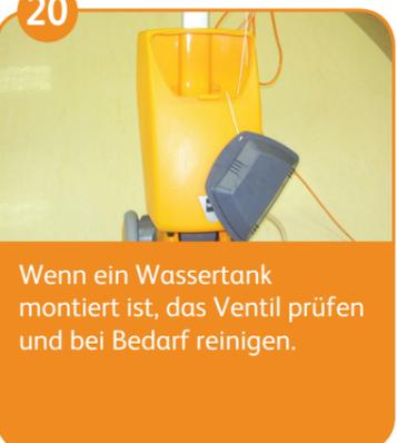
Wenn ein Wassertank montiert ist, das Ventil prüfen und bei Bedarf reinigen.
