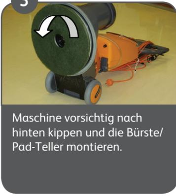
Maschine vorsichtig nach hinten kippen und die Bürste/ Pad-Teller montieren.
