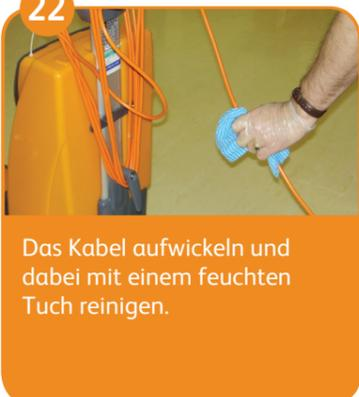
Das Kabel aufwickeln und dabei mit einem feuchten Tuch reinigen.
