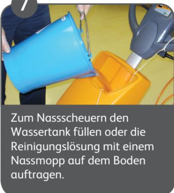
Zum Nassscheuern den Wassertank füllen oder die Reinigungslösung mit einem Nassmopp auf dem Boden auftragen.
