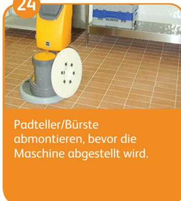
Padteller/Bürste abmontieren, bevor die Maschine abgestellt wird.
