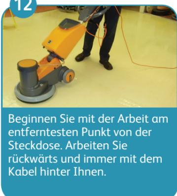
Beginnen Sie mit der Arbeit am entferntesten Punkt von der Steckdose. Arbeiten Sie rückwärts und immer mit dem Kabel hinter Ihnen.
