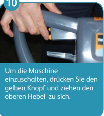
Um die Maschine einzuschalten, drücken Sie den gelben Knopf und ziehen den oberen Hebel zu sich.
