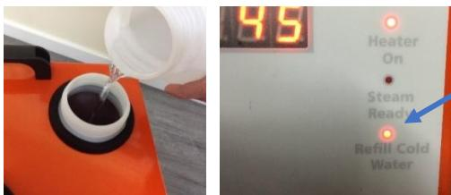
*Un signal sonore retentira et la vapeur ne sortira plus de l'embout lorsque l'on appuie sur l'interrupteur à vapeur de la poignée.*
