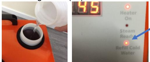
*Irá soar um alarme e o vapor deixará de sair do bocal quando o interruptor de vapor na pega for premido.*
