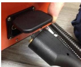
Vérifiez qu'il est correctement fixé et que la goupille du clapet est engagée dans le trou du tuyau.
