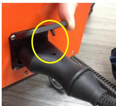
*Stellen Sie sicher, dass der Dampfschlauch nicht herausgezogen werden kann.*
