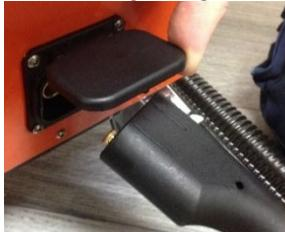
Säkerställ att den är intrytt hela vägen in och att sprinten på klaffen hakar fast i hålet på slangen.
