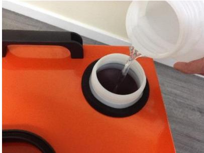
*Als ander water dan schoon en koud water in de watertank wordt geplaatst, zal de garantie van de fabrikant ongeldig raken.*
