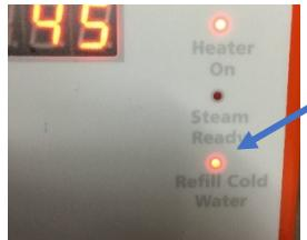
При нажатии выключателя подачи пара на ручке раздается звуковой сигнал, и пар больше не будет выходить из форсунки. Насосы не будут работать, когда бак для холодной воды пуст.
