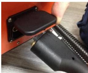
Accertarsi che sia completamente inserito e che il perno sulla linguetta si blocchi nel foro sul tubo.
