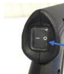
*Die Griffsteuerungen am Dampfschlauch sind jetzt aktiv. Der schwarze Wippschalter am Schlauchgriff lässt Dampf ab, wenn er gedrückt wird.*
