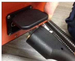
Stellen Sie sicher, dass er bis zum Anschlag eingeschoben wird und der Stift an der Klappe in das Loch am Schlauch einrastet.
