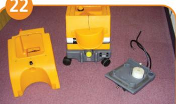
Schmutzwassertank leeren, abnehmen und reinigen.
