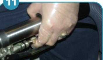
Die Spritzdüse flach in Richtung Boden halten, den Auslöser betätigen und mit der Arbeit beginnen.
