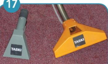
Für Stiegen, Kanten, Ecken und Polstermöbel ist mit der Handdüse zu arbeiten.
