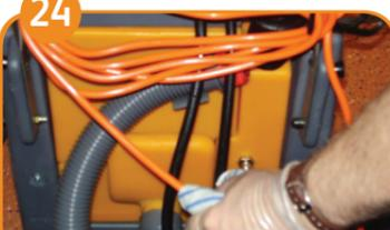
Kabel aufwickeln, dabei auf Schäden prüfen und mit einem feuchten Tuch reinigen. Kabel nicht verwinden.
