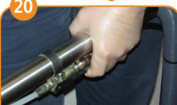
Pumpe ausschalten und den Auslöser betätigen, um den Druck von der Zuleitung zu nehmen.
