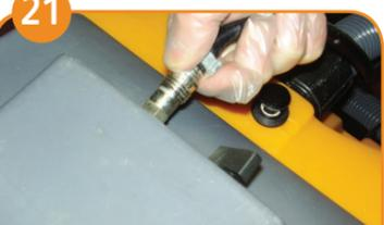
Sauger ausschalten und alle Schläuche lösen. Stellen Sie sicher, dass kein Schmutzwasser vom Saugschlauch entweichen kann.
