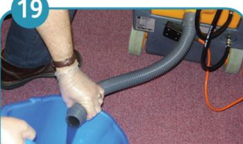
Gerät sofort ausschalten und den Schmutzwassertank über den Entleerschlauch entleeren.
